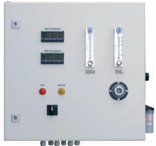
Mesa Industrie-Elektronik GmbH, bietet in Form eines CO<sub>2</sub>-Gasanalyse-Systems eine kostengünstige Lösung des Problems. Es handelt sich dabei um einen Kleinschaltschrank zur CO<sub>2</sub>-Messung. Durch seinen modularen Aufbau, kann das System mit beliebigen Komponenten, wie beispielsweise einer CO-Messung, ergänzt werden.
